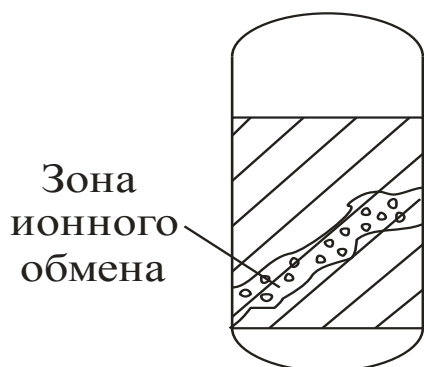
Рисунок 3.5 – Схема перекося «фронта» ионного обмена в фильтре
